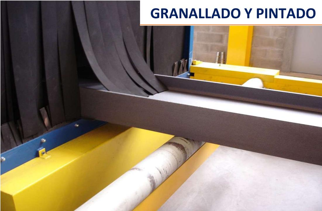
El granallado es una técnica de tratamiento de limpieza superficial por impacto a gran velocidad (65-110 m/s), logrando un excelente grado de limpieza y una correcta terminación superficial. Este proceso elimina los contaminantes de la superficie mejorando la adherencia de cualquier tipo de revestimiento o pintura, brindando un mejor aspecto visual de la pieza.
