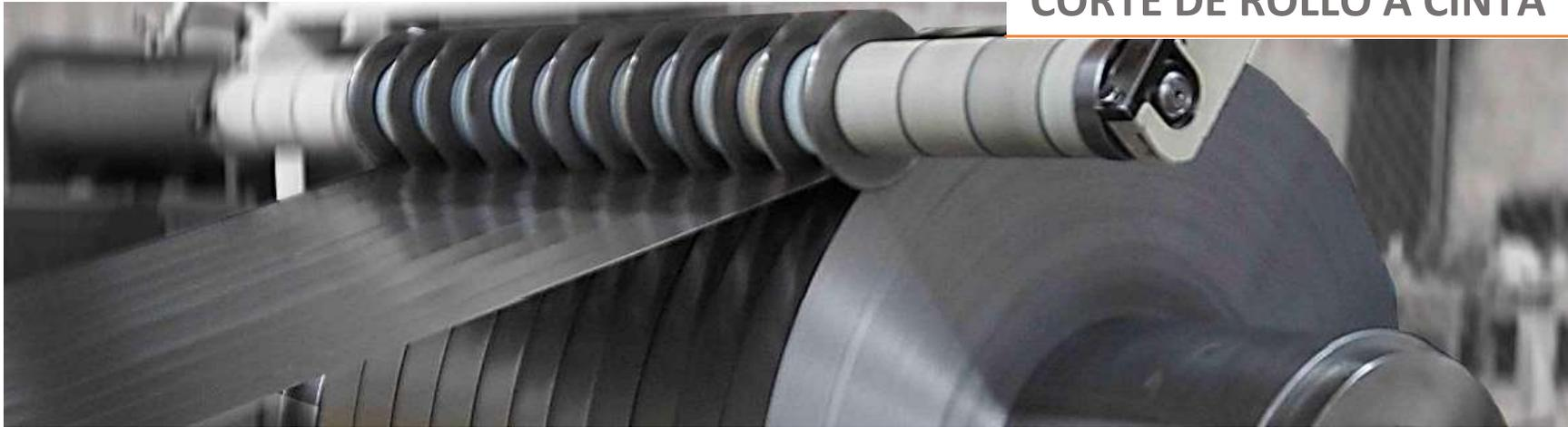
Proceso también conocido como “Corte de Rollo a Cinta”, el cual consiste en cortar la lámina que viene en rollo a cintas de diferentes anchos. También puede hacer desbastes sin realizar el corte.
