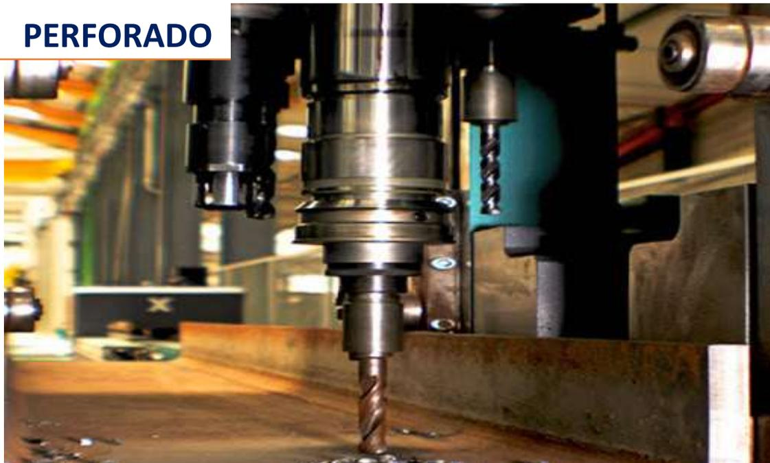
Cuenta con 3 taladros independientes para la perforación de perfiles, posicionados tanto en eje vertical como horizontal y coordinados simultáneamente para perforar distintas caras. Se obtienen piezas terminadas en un mismo ciclo, gracias a su sistema de automatización que puede sincronizar el corte y barrenado.
